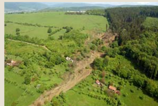
Horní část zemního proudu a kontakt spodních částí dvou sesuvů v Brumově-Bylnici, místní části Hluboče, foto I. Baroň, 2006.
