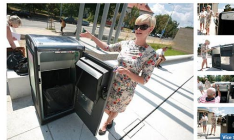
Nové odpadkové koše u brněnského Janáčkova divadla. Díky lisu pojmu až sedmkrát víc odpadu, navíc mají v sobě zařízení, které ohlásí, že jsou plné. Autor: DENÍK/Drahomír Stulík
