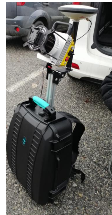
Technológia Lidaretto od firmy Geotech - kompaktný a univerzálny systém mobilného mapovania - LiDAR
