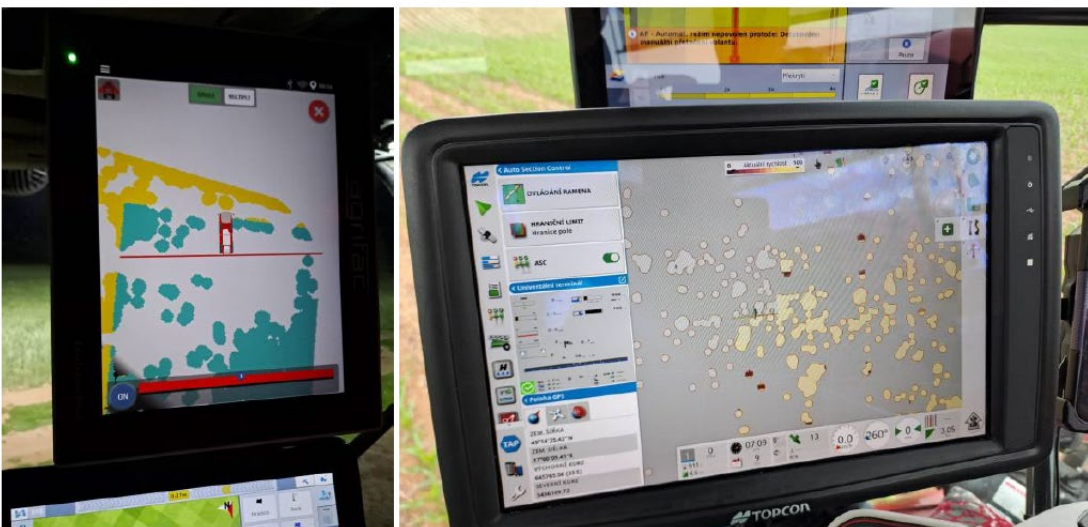
Obr. 16 Aplikáční mapy nahrané do palubního terminálu postřikovače Agrifac (vlevo) a Horsch (vpravo)
